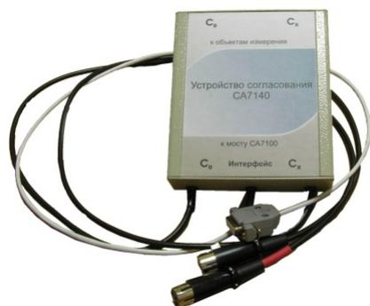
Устройство согласования автоматизированное СА7140 (далее – Устройство СА7140) совместно с Мостом СА7100 осуществляет дифференциальный контроль изоляции объектов (например, трансформаторов тока), находящихся под рабочим напряжением, а также выполняет контроль параметров защитных резисторов устройств присоединения. Процесс измерения полностью автоматизирован.
